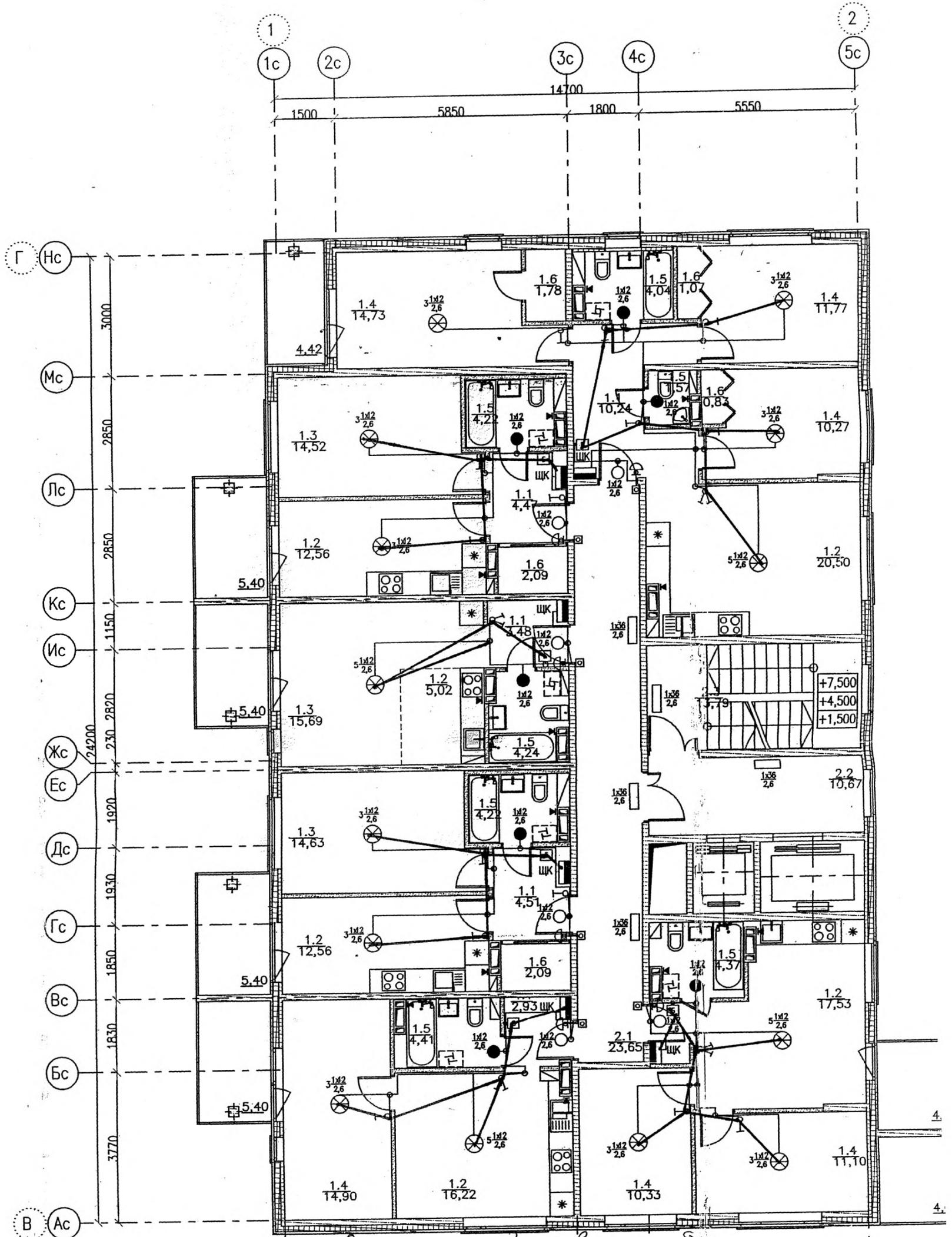
Типовой этаж раскладки осветительной сети нижнего этажа в трубах ПНД-РДБ.
